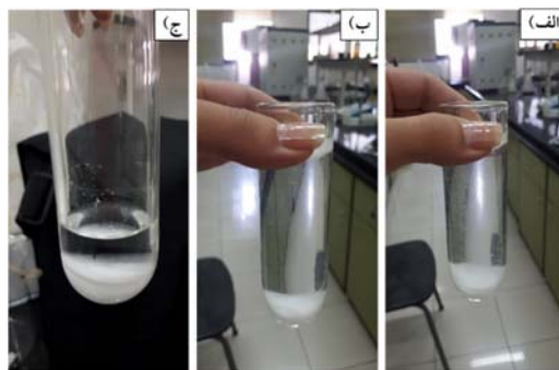
شکل ۴: پس از مراحل مختلف فرایند سانتریفیوژ بمدت (الف) ۴ دقیقه (ب) ۲۰ دقیقه (ج) ۳۲ دقیقه
