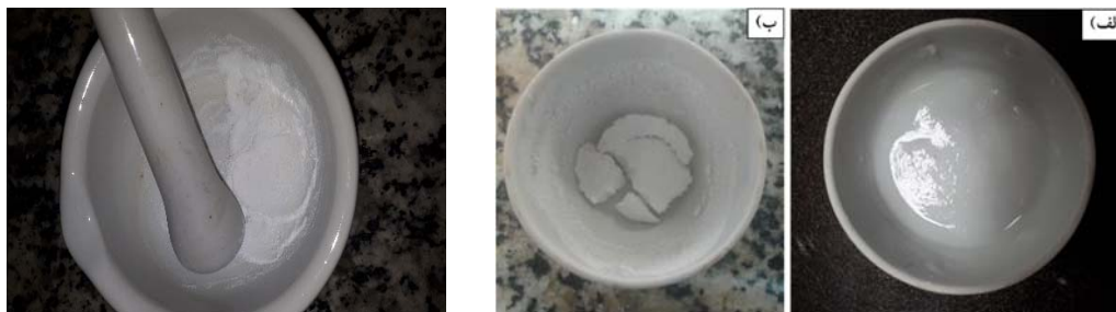
شکل ۵: رسوب واکنش الف) پس از سانتریفیوژ ب) پس از خروج از کوره شکل ۶: پودر سیلیکای حاصل
